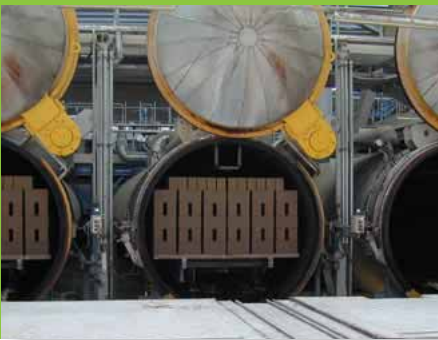
Abb. 8: Autoklaven zur Herstellung von Alpha-Halbhydrat
